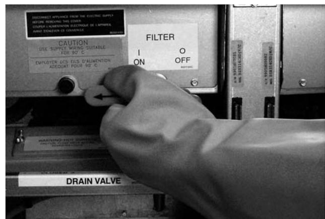
5. Die Filterpumpe zieht das Fritierfett/Öl durch den Filter und pumpt es in einem 5 Minuten langen Vorgang, der als Klären bezeichnet wird, zurück durch die Fritiermaschine. Beim Klären wird das Fett/Öl gereinigt, indem Feststoffteilchen im Filter gefangen werden.
