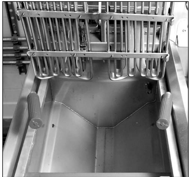
**Das Korbstützregal aus der Fritierwanne entfernen, die Heizelemente in die obere Stellung anheben und die Druckdusche einrasten lassen.**
