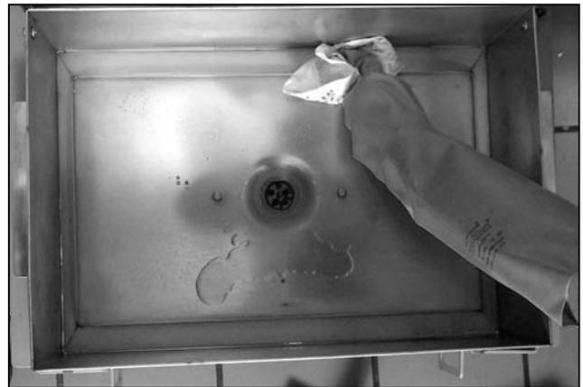
2. Nachdem geprüft wurde, ob das metallene Filtersieb unten in der Wanne ist, einen Bogen Filterpapier auf die Wanne legen; Es muss auf allen Seiten überlappen.
